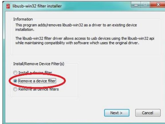
Далее в списке выбираем наше устройство, сверяя его VID 16C0 и PID 05DF. Нажимаем "Удалить".
